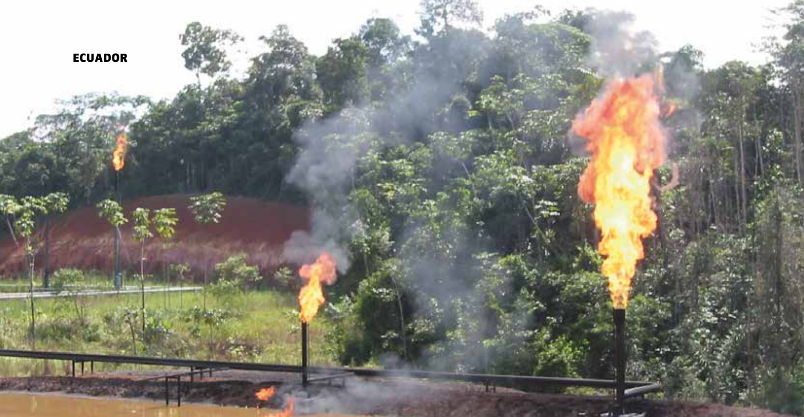
Zusammen mit dem Rohöl gefördertes Erdgas wird im Regenwald bei Lago Agrio einfach abgefackelt.
